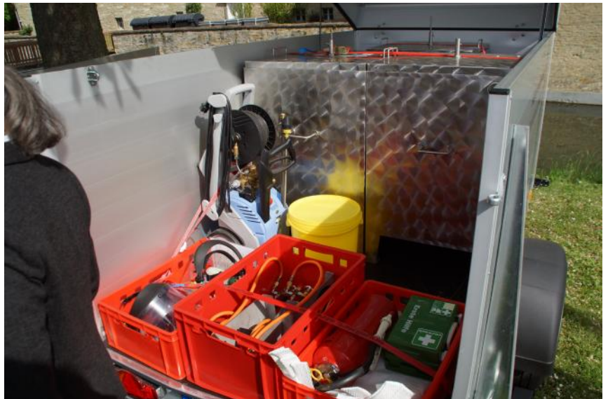
Ausstattung BiG-Mobil: u.a. 3 Kochkessel à 100 l mit leistungsstarken Gasbrennern, Hochdruckreiniger, Schatzanzüge, Feuerlöscher und Verbandskasten.
